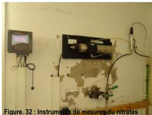
Figure. 32 : Instruments de mesures du nitrates (après traitement) et conductivité.
