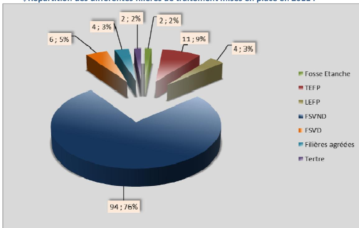
La réglementation prévoit en effet que selon le type de sol en place, l'installation n'est pas la même afin de s'adapter aux caractéristiques du sol, à son pouvoir épurateur, à sa capacité d'infiltration.... (TEFP : Tranchées d'Épandage à Faible Profondeur ; LEFP : Lit d'Épandage à Faible Profondeur ; FSVND : Filtre à Sable Vertical Non Drainé ; FSVD : Filtre à Sable Vertical Drainé...).
